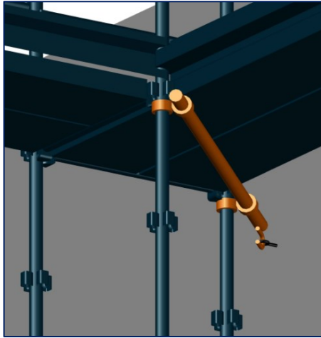
Figure 49: Amarrage dans un angle
