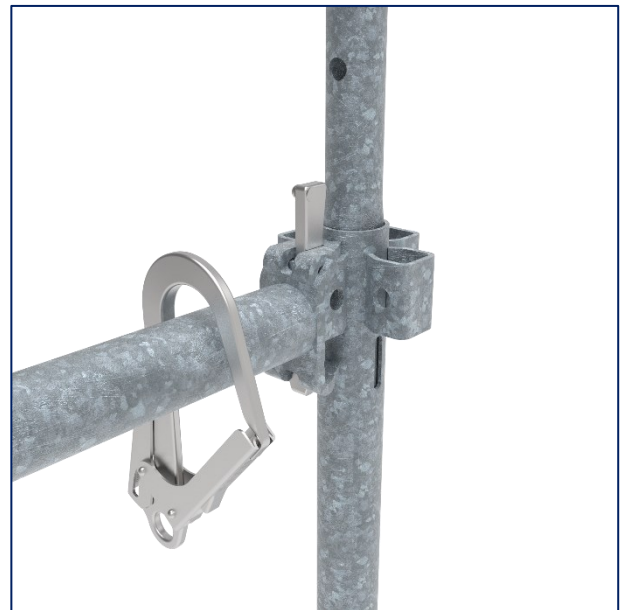
Figure 15: Point d'accroche sur le longeron claveté à 1 m au-dessus du plancher sur lequel se trouve le personnel
