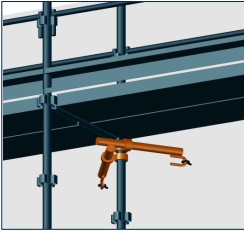
Figure 43 : Amarrage en V sur file intérieure
