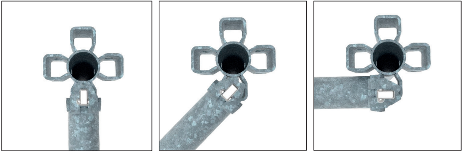
Figure 4: Montage à 0° (gauche), 45° (centre) et 90° (droite) d'un longeron sur le nœud M368
