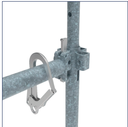
Figure 15: Point d'accrochage sur le longeron claveté à 1 m au-dessus du plancher sur lequel se trouve le personnel
