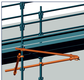
Figure 41 : Amarrage en V sur file extérieure
