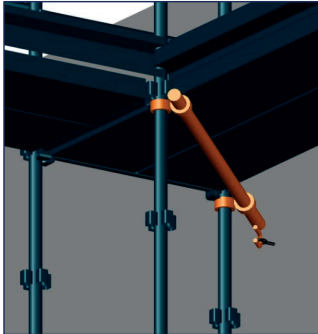
Figure 49: Amarrage dans un angle
