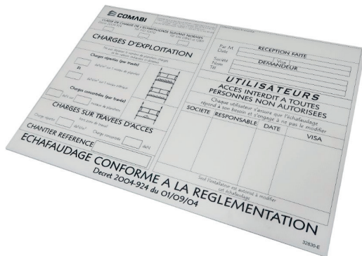
Figure 17 : Exemple de panneau Charges d'exploitation
