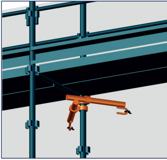
Figure 43 : Amarrage en V sur file intérieure
