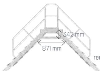
à partir d'une hauteur de 1300 mm, renfort sous plancher de 342 mm de haut
