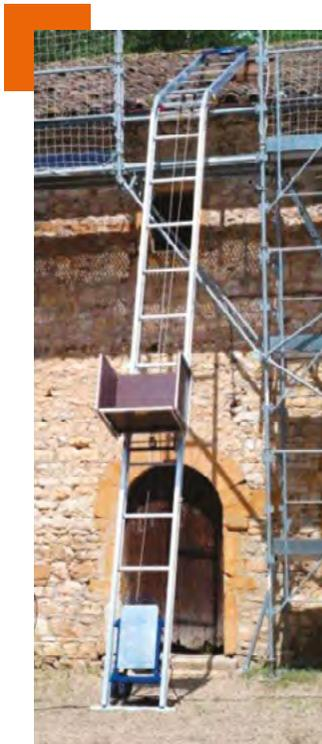
**CAISSE INTERCHANGEABLE AVEC SUPPORTS DE CHARGEMENT ADAPTÉS À CHAQUE MÉTIER. DISPONIBLES SOUS FORME DE PACKS.**
