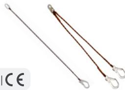
Longes cordes gainées tressées en polyamide. Limitent les déplacements de l'utilisateur et lui interdisent d'approcher de zones à risque de chute. Ceci est un dispositif de retenue et non d'anti-chute. Connecteurs du point d'ancrage Ø 54 mm à fermeture automatique. Connecteur du harnais Ø 18 mm (longes simples) à fermeture manuelle à vis et Ø 18 mm à fermeture automatique (longe double).
