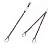
Longes rétractables anti-chute permettant de faciliter les déplacements : longueur rétractée 1,35 m et longueur allongée 1,70 m. Équipées d'un absorbeur d'énergie pour réduire la force de choc en cas de chute. Connecteurs du point d'ancrage Ø 54 mm à fermeture automatique. Connecteurs du harnais Ø 18 mm à fermeture automatique (longes simples et doubles).
