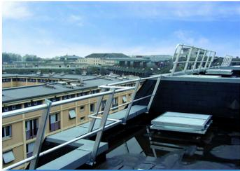
Dans le cas des garde-corps fixes, Tubesca-Comabi a conçu trois types de **supports de potelets** : en Z, en platine et en applique pour se fixer à différentes structures d'accueil (acrotères acier, béton, pierre ou lisse filante). Une fois la fixation déterminée, il est également possible de sélectionner le type de potelet (droit ou incliné) pour conserver l'esthétisme du bâtiment.
