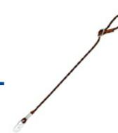
Longe corde gainée tressée en polyamide. Longueur réglable de 0,85 m à 2,00 m (hors connecteurs). 1 extrémité en boucle cousue pour l'accrochage et 1 extrémité en boucle simple tenue par un régulateur de longueur en métal. 2 connecteurs en acier Ø 18 mm à fermeture automatique.
