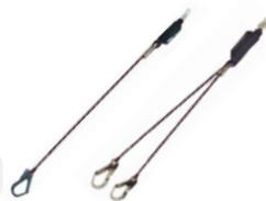
Longes cordes gainées tressées en polyamide. S'utilisent lors d'un risque de chute. L'absorbeur intégré dissipe l'énergie lors d'une chute et limite ainsi la force de choc ressentie par l'utilisateur. Connecteurs du point d'ancrage Ø 54 mm à fermeture automatique. Connecteurs du harnais Ø 18 mm à fermeture automatique (longes simples et doubles).
